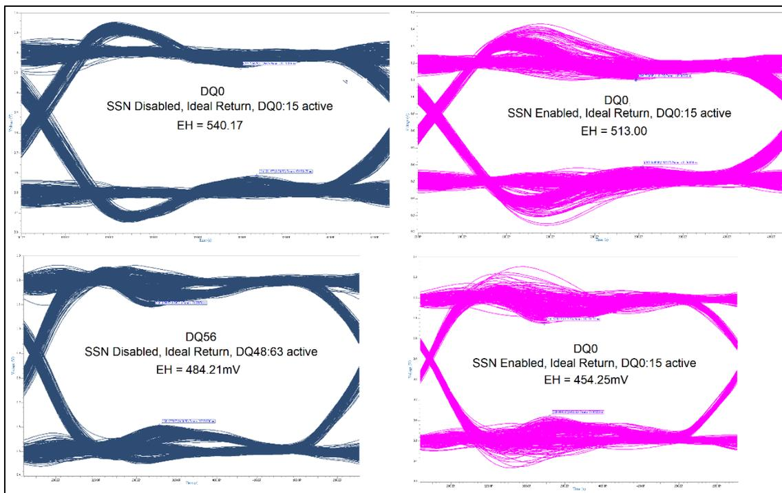
Figure 34 - Effect of SSN on DQ0 and DQ56
